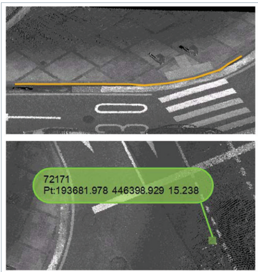
그림 6. 3차원 포인트 클라우드 자료를 이용한 도로선형추출(위)과 표고점 측량(아래)
