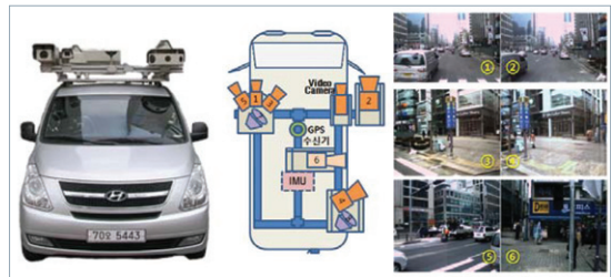
그림 1. 디지털 카메라 기반의 차량 MMS와 획득된 데이터
