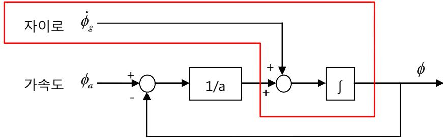
먼저 자이로 센서로부터 측정한 각속도  $\omega$ 와  $\omega$ 의 평균  $\omega_m$  간의 차를 계산함으로 자이로 센서의 바이어스를 제거한 각속도  $\Delta\phi_g$ 를 계산한다.  $\Delta t$ 는 각속도 센서의 데이터 측정 주기다.
