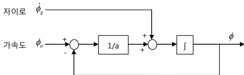
블록 다이어그램을 살펴보면, 가속도 센서로부터 측정한 각도( $\phi_a$ )는 센서의 예측 각도( $\phi$ )와의 차를 이득  $1/a$ 를 곱하여  $\phi$ 에 적분한다. 그리고 차이로 센서로부터 측정한 각속도( $\dot{\phi}_g$ )는  $\phi$ 에 그대로 적분한다. 여기서 주의할 점은,  $\dot{\phi}_g$ 는 센서 좌표계를 기준으로 하는 각속도값이고,  $\phi_a$ 는 전역 좌표계를 기준으로 하는 각도값이라는 점이다. 이 때문에 적분하는 방법에 차이가 있다.
